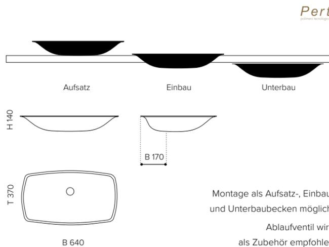
Montage als Aufsatz-, Einbau- und Unterbaubecken möglich. Ablaufventil wird als Zubehör empfohlen
